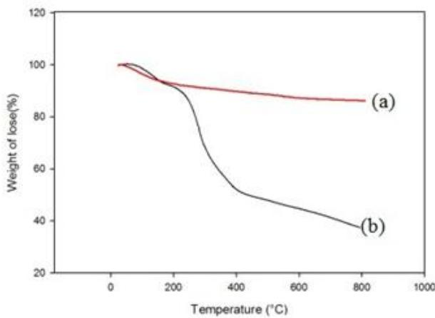
Fig. S1. Thermo gravimetric analysis of a)  $\text{NiFe}_2\text{O}_4@\text{SiO}_2$  b)  $\text{NiFe}_2\text{O}_4@\text{TASDA-Pd}(0)$ .
